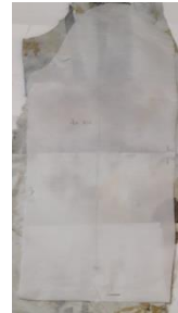
Resim.30.Üst Kol Kalıbın Kumaşa Yerleştirilmesi
