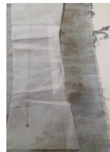
Resim .28.Arka Orta Kalıbın Kumaşa Yerleştirilmesi
