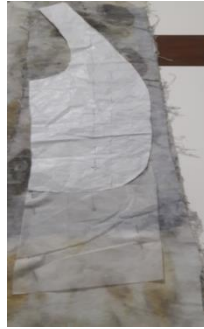
Resim.27 Sağ önyan Kup kalıbın kumaşa yerleşmesi
