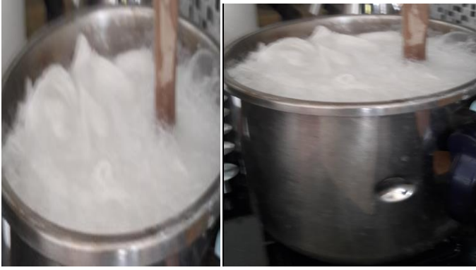
Resim. 16. Şap ve taş soda ile suda kaynayan kumaş parçaları
