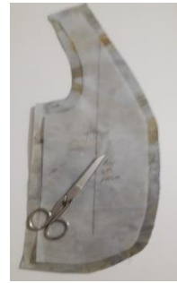
Resim.27 Sağ önyan Kup kalıbın kumaşa yerleşmesi
