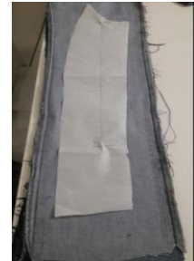
Resim.31.Alt Kol Kalıbın Kumaşa Yerleştirilmesi
