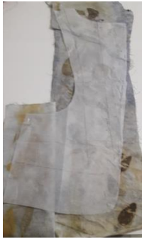
Resim.26.Ön orta kalıbın kumaşa yerleşmesi
